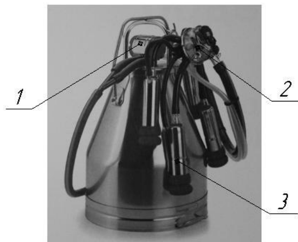
Рисунок 2.16 - Аппарат доильный «CLASSIC» фирмы "Westfalia Surge": 1- пульсатор; 2-коллектор; 3-стакан доильный
